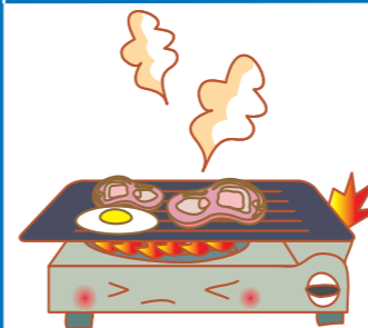
カセットこんろを覆うような大きな鉄板や鍋を使わない
