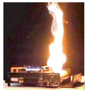
カセットボンベを正しく装着しなかったため、漏れたガスに引火しました 【NITEの再現実験】
